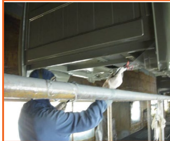
Dodatni nanos plastizola na karoseriju (kabinu)
