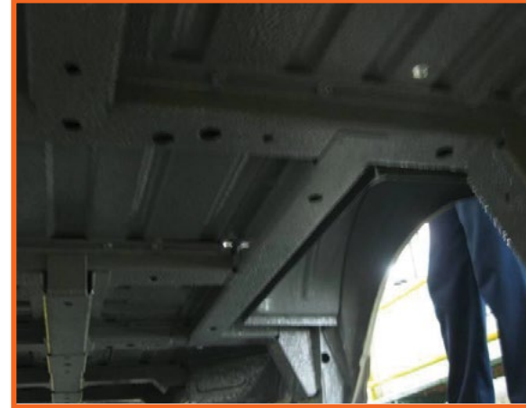
Pogled na zaštićenu karoseriju sa nanosenim plastizolom
