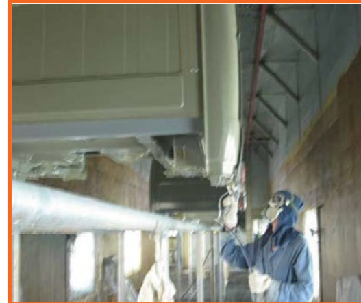
Dodatni nanos plastizola na karoseriju (kabinu)
