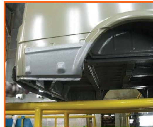
Pogled na zaštićenu karoseriju sa nanosenim plastizolom
